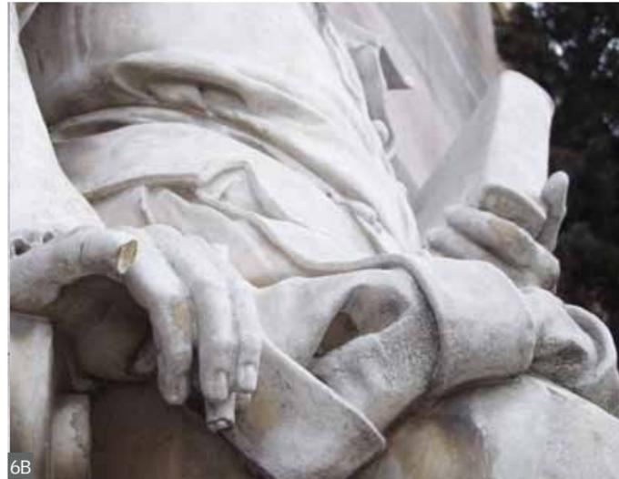
Figura 7.- Aspecto general y detalles del estado de deterioro de la escultura de Velázquez con costras negras, disgregación intergranular y desplazaciones.
